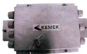
Рисунок 4 – Схема пломбировки соединительной коробки
